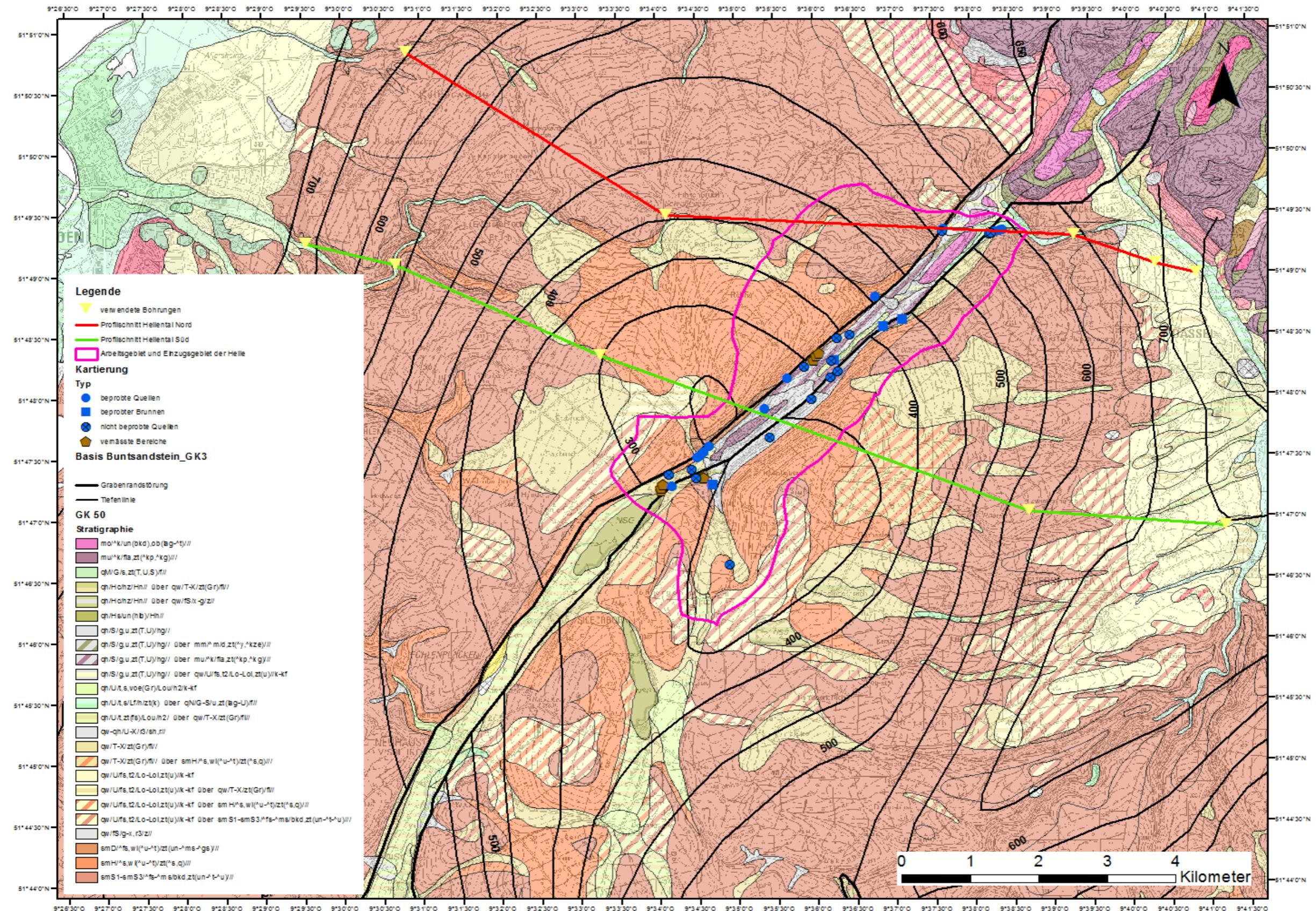
Anhang 2: Übersichtskarte der geologischen Profilschnitte nach LBEG (2018), erstellt anhand von Bohrprofilen in Abgleich zum Tiefenlinienplan nach Lepper (1979)
