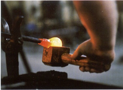
Zuerst wird eine kleine Menge des flüssigen Glases aus dem Ofen entnommen und zu einer Blase geformt...
