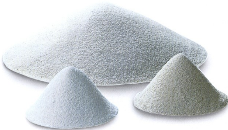
Die Grundstoffe der Gläser sind Quarzsand, Soda und Kalk.
